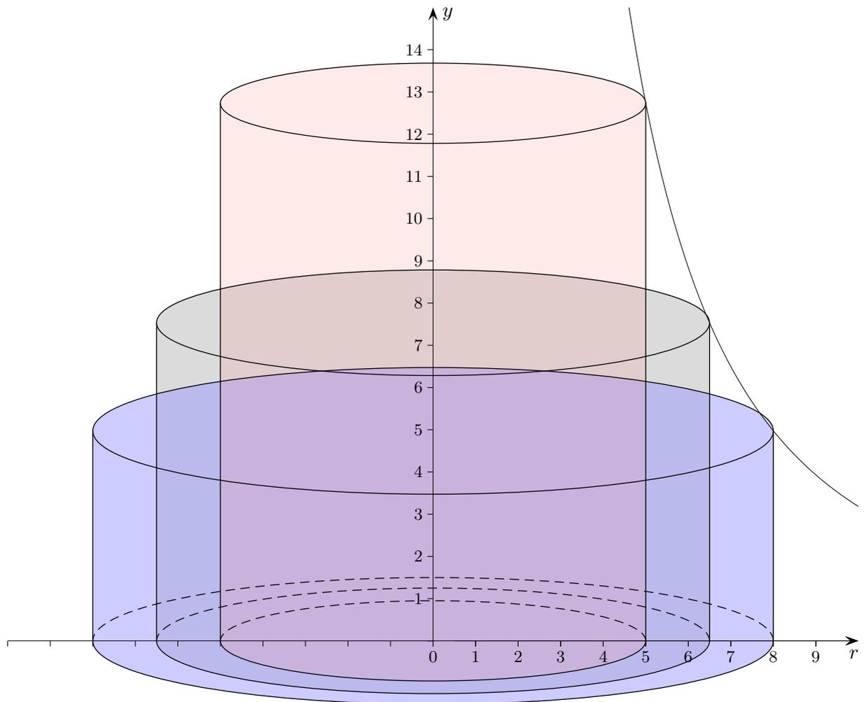
Die Zylinderhöhen werden durch die Funktion  $h(r) = \frac{1000}{\pi r^2}$  bestimmt.
